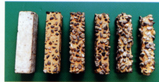
〈コンクリートがとけるようす〉 橋などにつかわれるコンクリートも、たった30日でボロボロになります（一番左がもとの大きさ）
