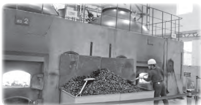
石炭を炉にくべ続けゆっくりと蒸留する
